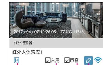
在红外报警器列表界面，点选刚才添加的红外人体感应器相关按钮，您可以通过手机远程设置，当红外感应器检测到任何动作时，传感器会立即发送指令并启用设置好的智能安居情景模式。
