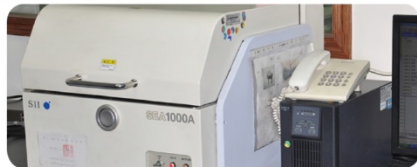
XRF 測試機 分析重金屬元素含量
