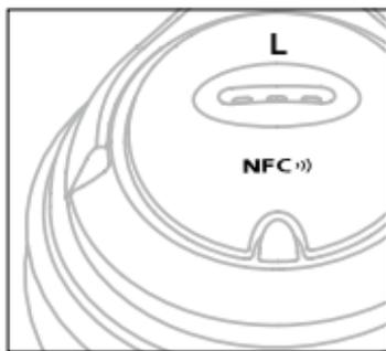
当手机有 NFC 功能时,以手机 NFC 部位轻触耳机上 NFC 标志,蓝牙即可自动快速配对连接。请注意·蓝牙、NFC 应处在开启状态。NFC 技术拥有安全、便捷、功耗低等特点。
