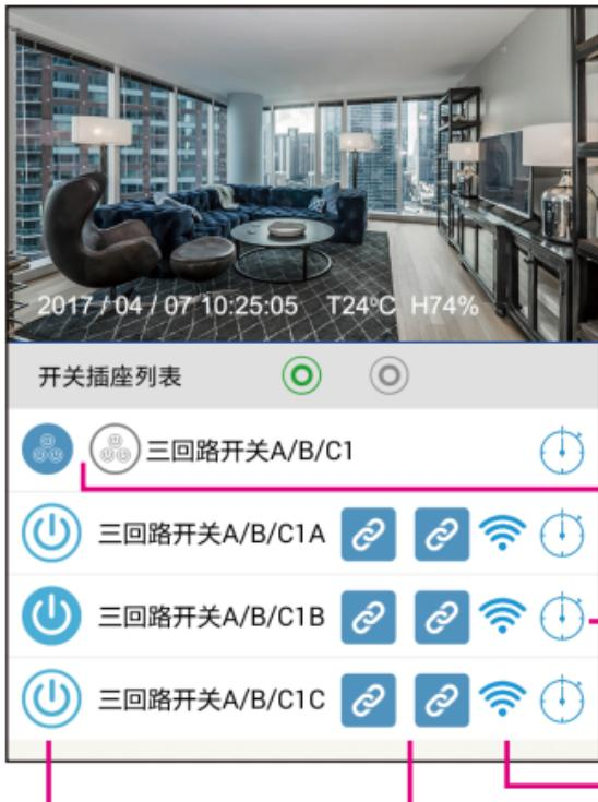
點選界面中開關圖示可直接控制開關ON/OFF
