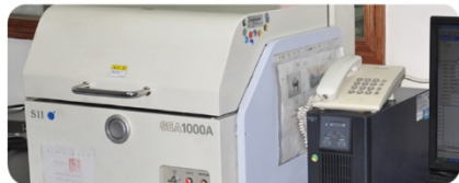
XRF 測試機 分析重金屬元素含量
